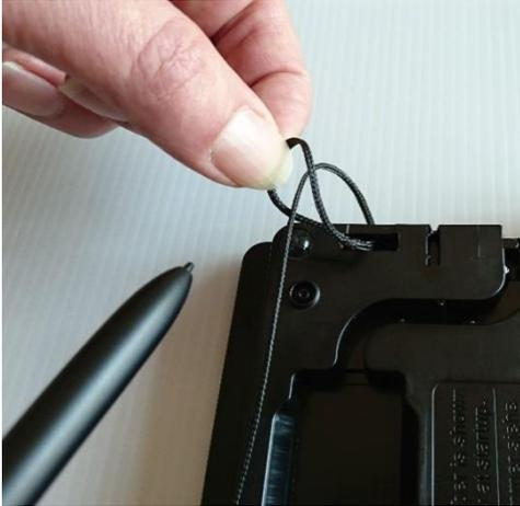
1. Bitte entfernen Sie zunächst die am Pad befestigte Kordel zusammen mit dem alten Stift, indem Sie das Unterschriftenpad mit dem Bildschirm nach unten legen, die Schlaufe der Kordel etwas nach oben ziehen, und den Stift durch die Schlaufe schieben. Somit sind durch das Ausfädeln Kordel und duraPen vom Unterschriftenpad getrennt.
