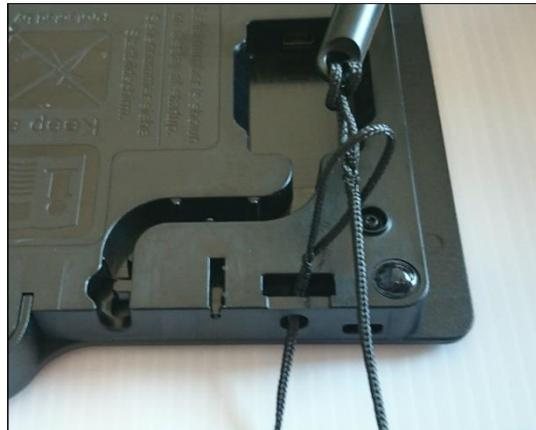
4. Schieben Sie nun bitte das freie Ende der Kordel ein Stück weit durch die Öffnung an der Rückseite Ihres Unterschriftenpads, so dass Sie den Stift durch die Schlaufe ziehen können.
